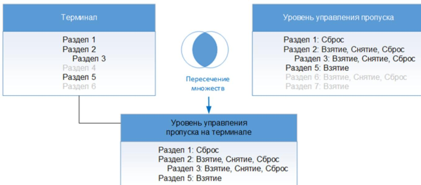
Рисунок 27 — Уровень управления пропуском в точке доступа
