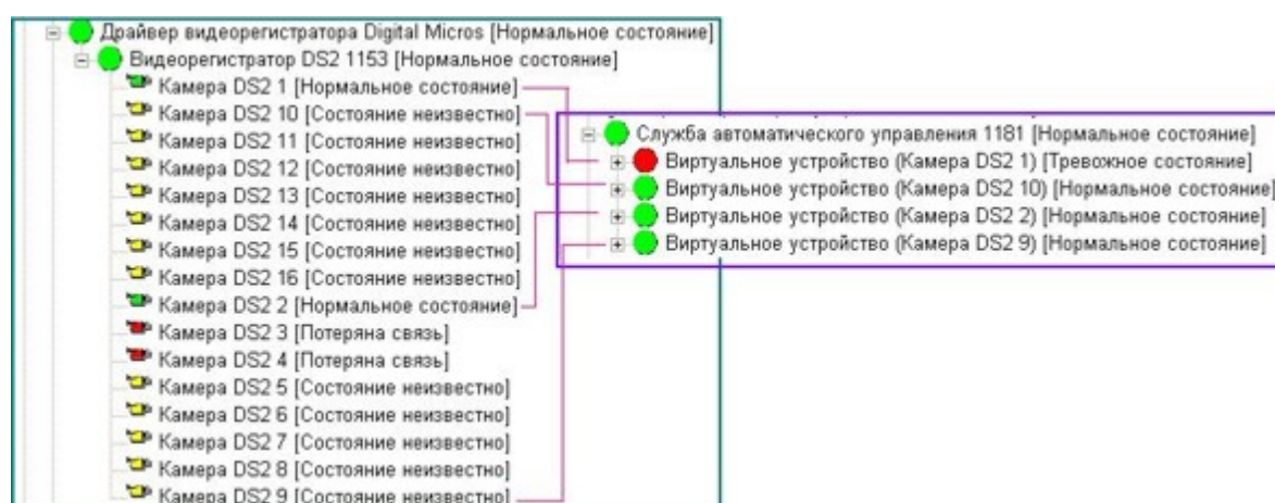
Рисунок 12 — Камеры и соответствующие им виртуальные устройства
