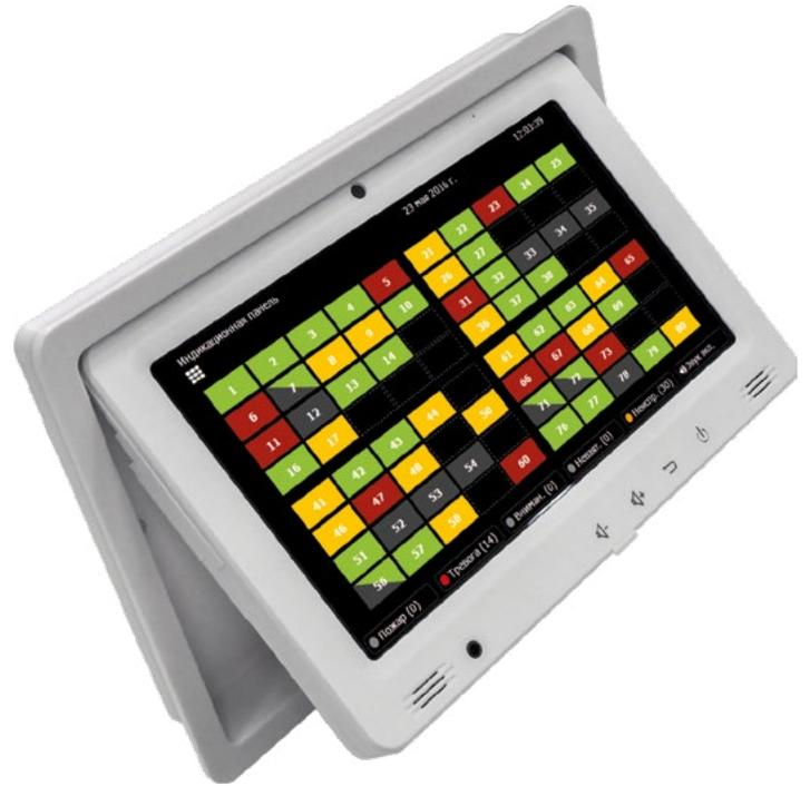
Интерактивная скремблированная клавиатура – дополнительная степень защиты от подбора кода, а «индикационная панель» обеспечивает масштабируемый интерфейс навигации по охраняемым объектам.
